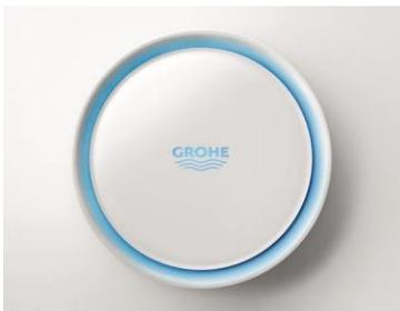
GROHE Sense misst die **Temperatur und Luftfeuchtigkeit** in einem Raum. Diese Werte gleicht das System dann automatisch mit festgelegten Grenzwerten ab und schickt sie an die GROHE Sense App auf dem Smartphone. Gleichzeitig sucht Sense den Boden nach Wasserspuren ab. Stellt der **Sensor** Überflutungen, ungewöhnliche Raumtemperaturen oder Luftfeuchtigkeit fest, wird automatisch ein Alarm an die App gesendet. So haben auch Frost- und Schimmelschäden keine Chance mehr!
